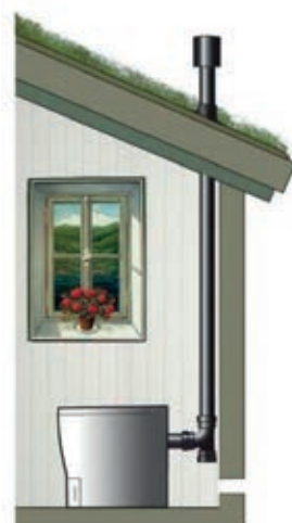
Ventilationsröret dras rakt upp och över taket.
