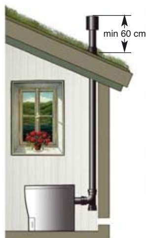
Ventilationsröret dras rakt upp och över taket.
