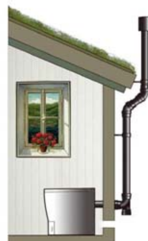
Ventilationsröret dras ut genom vägg. Max 2 x 45° böj och 1 x 90° böj.
